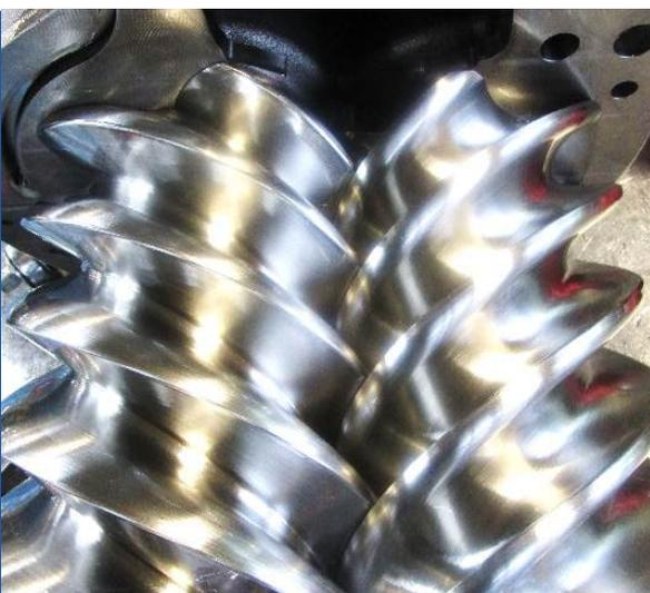
Les **compresseurs à vis** des équipements d'air conditionné sont particulièrement exposés aux contraintes d'exploitation des environnements dans lesquels ils fonctionnent.
