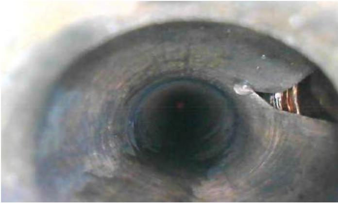
L'inspection par vidéo endoscopie permet d'authentifier la bonne qualité du contrôle par courants de Foucault, étape par étape.
