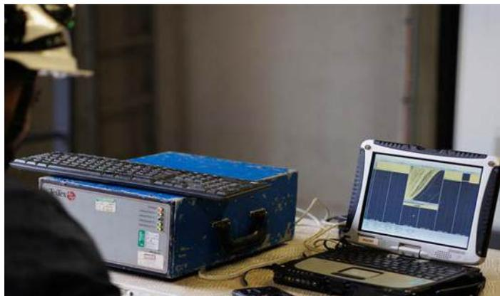
L'interprétation des données vibratoires collectées est un véritable examen mécanique approfondi. Les fréquences et les vitesses de rotation des organes en mouvement sont comparées avec les informations recommandées par nos experts
