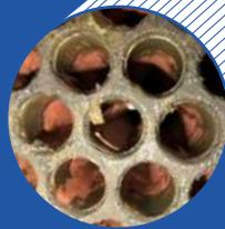
Les *échangeurs multitubulaires* sont particulièrement sujets à l'encrassement. Les souillures accumulées dans chacun des tubes *augmentent la consommation électrique* des unités de refroidissement, entraînant dans certains cas, de nombreux dysfonctionnements intempestifs.
